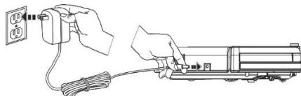
Vypnite vysávač na hlavnom vypínači, aby ste zamedzili jeho prípadnému pohybu. Potom zapojte 230 V napájací adaptér napriamo do vysávača. Plné nabitie batérie bude signalizované rozsvietením všetkých LED diód na hornom paneli.
