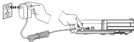
Vypněte vysavač na hlavním vypínači, aby jste zamezili jeho případnému pohybu. Poté zapojte 230 V napájecí adaptér napřímo do vysavače. Plné nabití baterie bude signalizováno rozsvícením všech LED diod na horním panelu.
