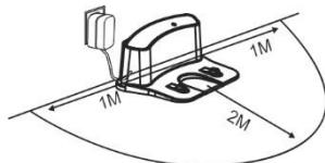
3. Umieść robota w stacji ładowania, a bateria zacznie ładować się automatycznie.
