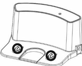
Skontrolujte minimálne raz týždenne oba bočné čistiace kefy spoločne s otvorom pre nasávanie vzduchu a odstráňte z nich namotané vlasy a ďalšie nečistoty. Bočná čistiaca kefka odstráňte vysávača odskrutkovaním skrutky s krížovou hlavou. Vyčistite tiež prach z otvoru pre nasávanie vzduchu.
