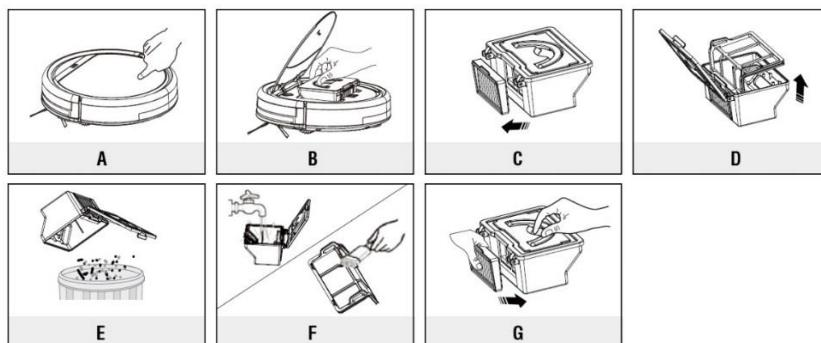
Co dwa tygodnie oczyszczaj filtr HEPA za pomocą szczotki do kurzu. Zalecamy wymianę filtra HEPA co 6 miesięcy. Jeśli opłuczysz zbiornik na kurz wodą, przed ponownym jego zamontowaniem musi dokładnie wyschnąć.
