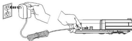
A főkapcsolóval kapcsolja ki a porszívót és csatlakoztassa közvetlenül a 230V hálózati adapterre. A teljes töltöttség elérésekor az összes LED világít
