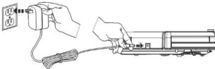
Wyłącz robota głównym przełącznikiem, aby się nie ruszał. Następnie podłącz do niego bezpośrednio zasilacz 230V. Zapalenie się wszystkich lampek LED na panelu oznaczać będzie pełne naładowanie baterii.
